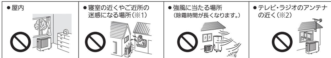
※1.ヒートポンプユニットはわき上げ中及び凍結防止運転中に運転音、振動が発生します。据付場所の状態で、運転音は大きくなります。また、わき上げ中は冷風がでますので、寝室の近くやご近所の迷惑になる場所への据え付けは避けてください。
