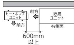
※薄型タイプは、メンテナンス時に右側面の外装ケースを取り外す場合があるため、左側面側を壁側に配置してください。右側面側を壁側に配置すると、メンテナンスができない場合があります。
