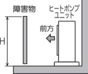
所要スペース(D1及びD2)は、障害物の高さ(H)によって変わります。風向ガイドを取り付ける場合は、下表を参照ください。ただし、設置条件によっては運転音が上がることがあります。
