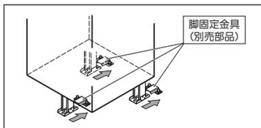
① 所定の位置にM12アンカーボルトを9本施工する
