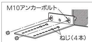
① 付属のねじ(4本/個)を使用して、上部振れ止め金具を上向きで本体に固定する(2カ所)
