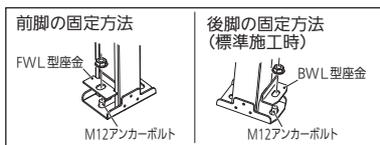
① 所定の位置にM12アンカーボルトを3本施工する
