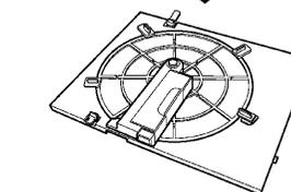
ダストボックスが正しく取付けられていないと、吸込パネルが取付けられません。
