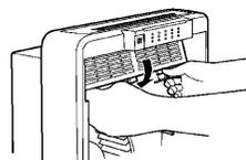
プラズマ電極上側を掛けてから、下側を押込む
