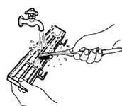
プラズマ電極を水洗いし、陰干して充分乾燥させる。
