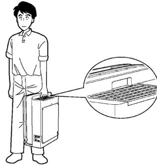
運転スイッチを「切」にして電源プラグを抜き、取っ手を持って移動してください。
