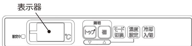
冷却運転を停止するときは、手順3の冷却入/切キーを3秒以上押し続けてください。
