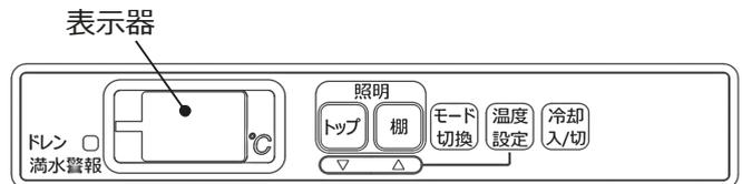
冷却運転を停止するときは、手順2の冷却入/切キーを3秒以上押し続けてください。表示が『--』に変わります。
