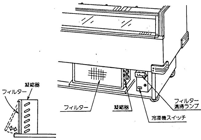
\*フィルターは上部を引抜けてから下部を押し込んでセットしてください。
