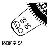
ご使用になる地区的電源周波数に応じて、左図のとおり、固定ネジをゆるめて、切替レバーをセットしてください。セット完了後は固定ネジを確実にしめてください。
