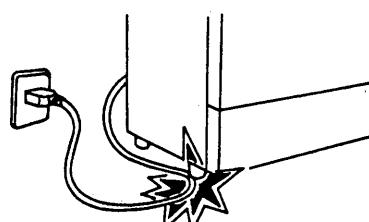
**アース及び漏電しゃ断器は必ず取り付けてください。**
