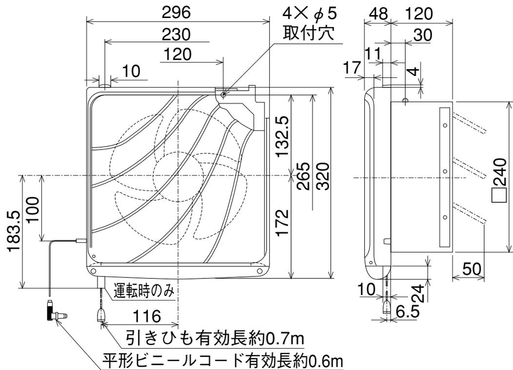
※防火ダンパー付ウェザーカバーを併用される場合は、壁厚を120mm以上確保してください。
