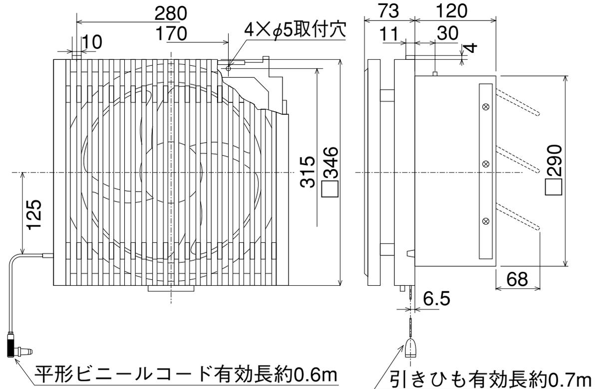
※防火ダンパー付ウェザーカバーを併用する場合は壁厚を120mm以上確保してください。
