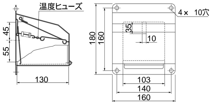
板厚:閉鎖部1.6mm ウェザーカバー部0.8mm (単位mm)
