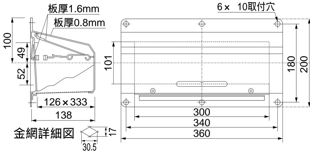
鋼板板厚 閉鎖部1.6mm ウェザーカバー部0.8mm (単位mm)
