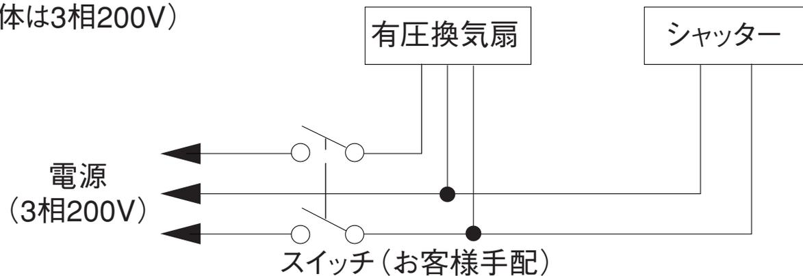
※ 電源コード2芯のシャッターは電源を切ると同時にバネによってシャッターが閉じます。
