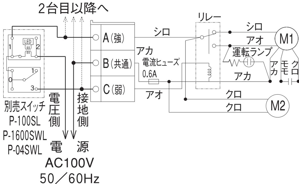
太線、破線部分の結線はお客様にて施工してください。
