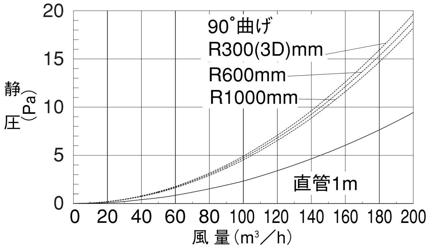
※90°曲げの圧力損失は、「曲げ形状による圧損（形状圧損）」のみです。
