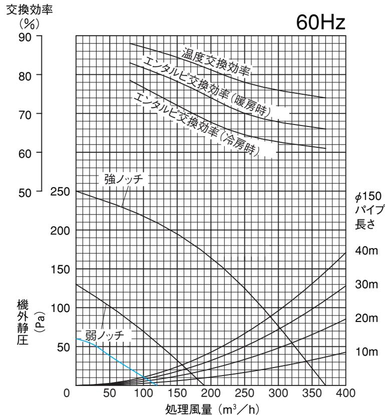
※ — 表示は微弱風量運転ユニット（システム部材）取付時
