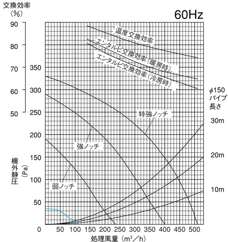
※ — 表示は微弱風量運転ユニット (システム部材) 取付時
