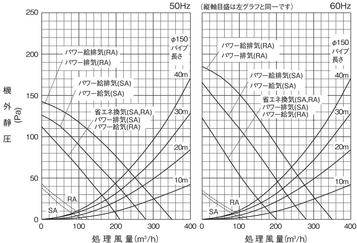
※-----表示は微弱風量運転ユニット(システム部材)取付時
