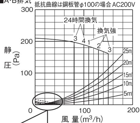
■ 24時間換気 設定2(50m<sup>3</sup>/h) 設定1(20m<sup>3</sup>/h)の場合
