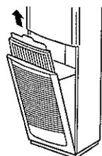
3 フィルターの取手を持って、矢印の方向に引き上げて外してください。
