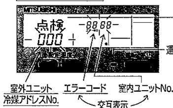
リモコンの機能選択 (14ページ参照) で、“異常時の連絡先”が設定されている場合は、連絡先の電話番号が表示されます。
