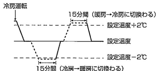
■体感温度を一定に保つように室温を自動的に調節しますので、室温が設定温度に到達した後は、冷房では少し高め、暖房では少し低めで運転します。（省エネサイクル自動運転）
