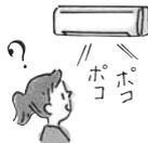
■ 換気扇を回したときドレンホースから室外の空気を吸込み、ドレンホース内の水が吸い上げられるときに出る音です。建物の給気口が開いていることを確認してください。風が強いときにも音が発生する場合がありますので、ドレンホースの先端を風が当たらない方向に向けてください。
