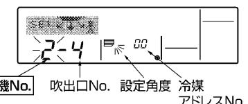
【手順③】…「冷媒アドレスNo.」を次のNo.にして確認します。(冷媒アドレスの最大はNo.15です)
