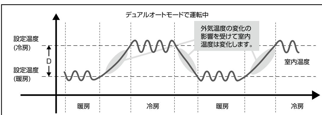
※冷房設定温度と暖房設定温度の差(D)の最小値は、接続する室内ユニットにより異なります。
