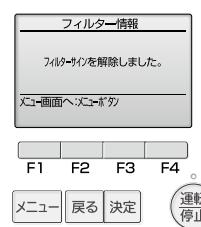
■必ずフィルター清掃を行ってから表示を消してください。表示を消すとユニットの運転時間もリセットされます。
