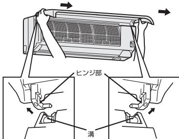
■丸洗いパネルは無理に引抜いたり、落下させない。丸洗いパネル破損の原因になります。
