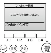
■必ずフィルター清掃を行ってから表示を消してください。表示を消すとユニットの運転時間もリセットされます。
