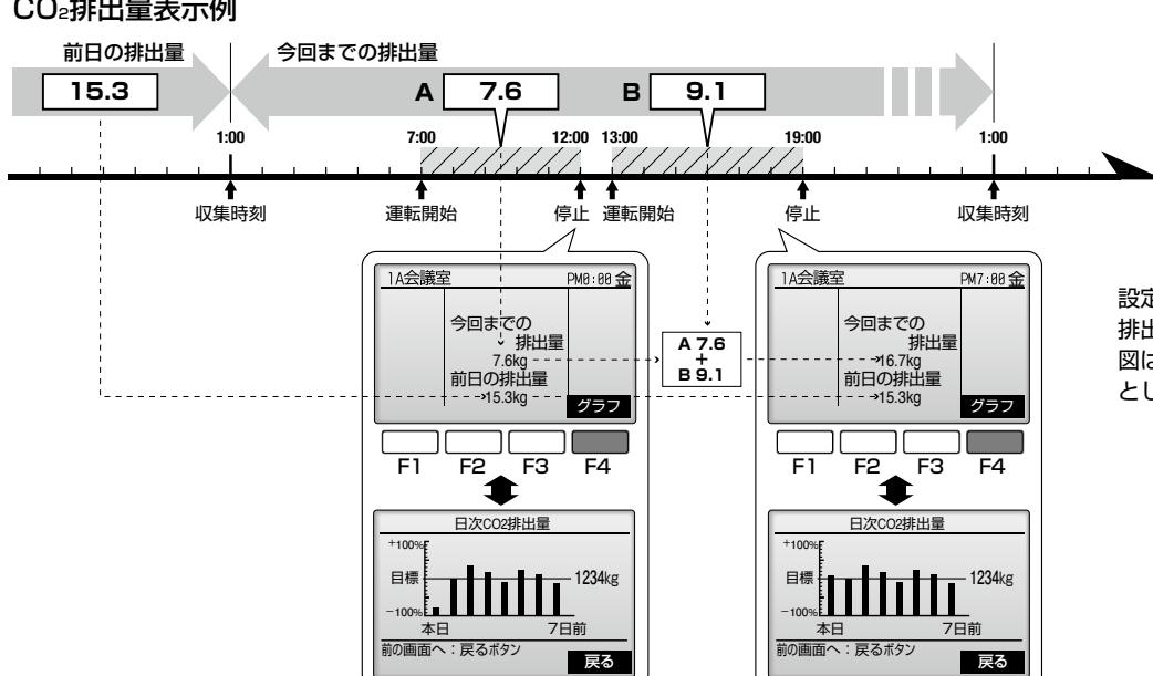
設定しました範囲内のCO<sub>2</sub>排出量を積算し表示します。
