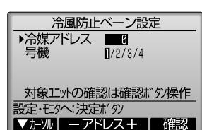
●設定する室内ユニットを確認したい場合、上記1の手順で「冷媒アドレス」と「号機」を選択し F4 ボタンを操作することで、対象室内ユニットのベーンのみ下吹きになります。
