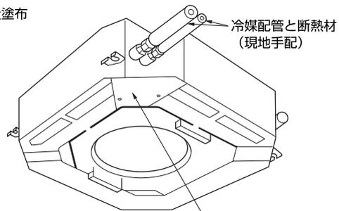
電気配線用サービスパネル取外し
