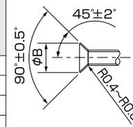
※従来のツールを使って冷媒R410A用のフレア加工をする場合は、上表を参考に加工してください。
