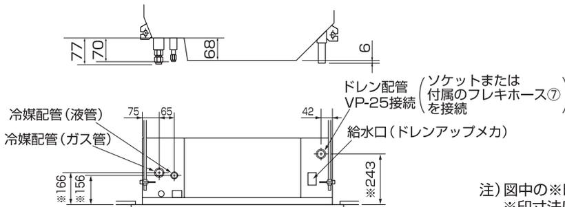
注) 図中の※印部の寸法は、別売多機能ケースメントを取付けた場合、※印寸法に135mm加算します。
