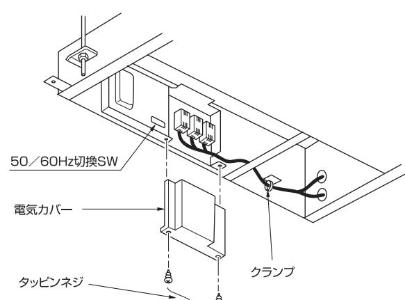
※電気品カバーは、電気品箱の奥側の爪に確実に差し込んでから、ネジ止め固定してください。
