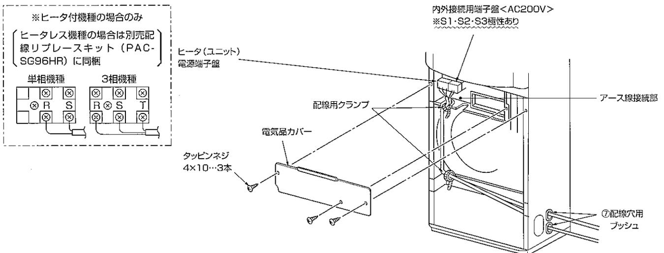
※電気品カバーは、電気品箱上部の爪の内側に確実に差し込んでから、ネジ止め固定してください。(電気品カバーが浮いた状態では、吸込グリルを取付けることができません)
