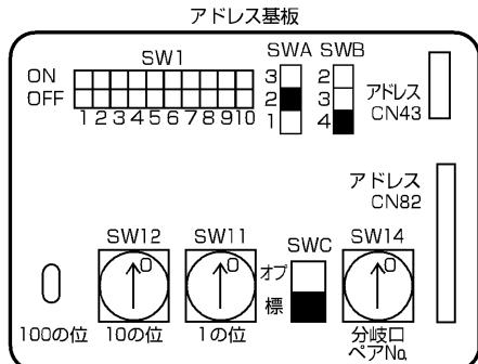
アドレス設定は電気品箱内のアドレス基板上のロータリスイッチにて設定します。
