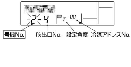
【手順③】…「冷媒アドレスNo.」を次のNo.にして確認します。(冷媒アドレスの最大はNo.15です)
