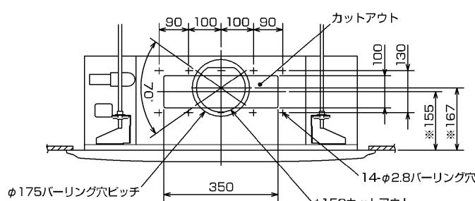
別売加湿器(別吊り方式)用ダクト接続口詳細図(両側面)
