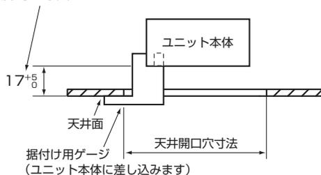
※化粧パネルを据付け後、ユニットの高さの微調整ができます。
