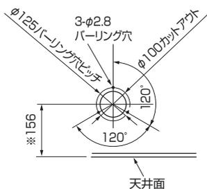
新鮮外気取入口詳細図(フィルター自動清掃ユニット取付け時は使用できません。)
