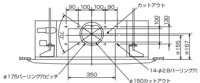
別売加湿器(別吊り方式)用ダクト接続口詳細図(両側面)
