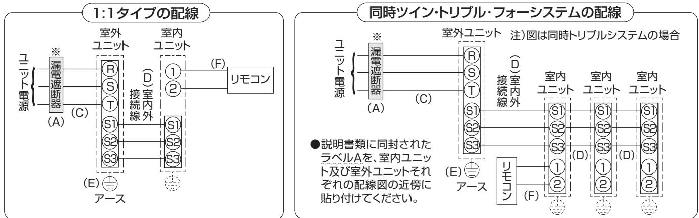
※電源には必ず漏電遮断器を取り付けてください。漏電遮断器は、地絡過負荷・短絡保護兼用のインバーター回路用遮断器(三菱電機製NV-Cシリーズ又は、その同等品)を選定してください。
