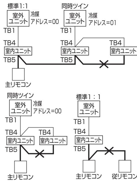
■リモコン線の総延長は500mです。ただし、リモコンを2台接続(例2)、(例3)でご使用の場合は200m以下にしてください。
