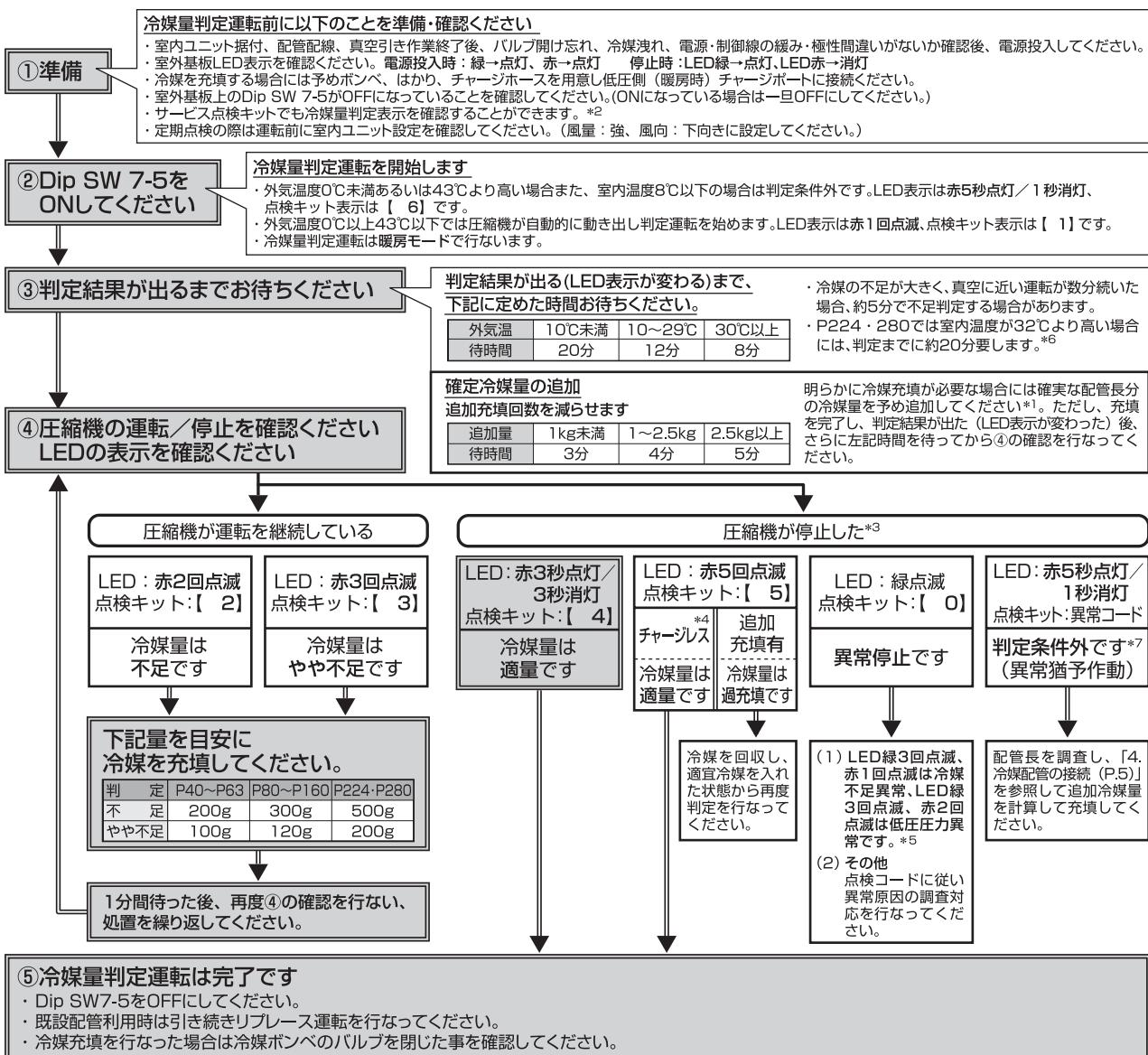
\*1 配管長を調査し、「4. 冷媒配管の接続(P5)」を参照して追加冷媒量を計算して充填し、再度判定を行ってください。
