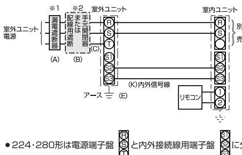
● 224・280形は電源端子盤 と内外接続線用端子盤 に分かれています。
