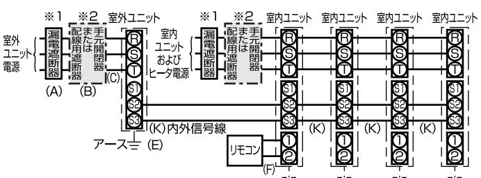
● 224・280形は電源端子盤 (S1, S2, S3) と内外接続線用端子盤 (K) に分かれています
