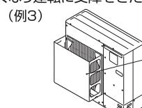
近くに壁などがある場合には壁面に吹出口が向くようにする。この時壁面までの距離は50cm程度にする。
