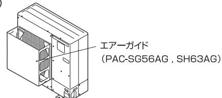
台風等の強風が吹出口に吹付けるような据付場所には別売エアーガイドを取付けてください。
