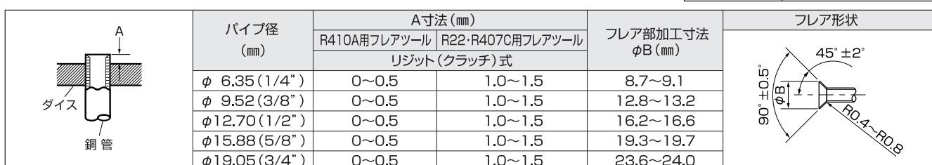
※従来のツールを使って冷媒R410A用のフレア加工をする場合は、上表を参考に加工してください。
