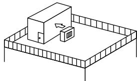
近くに壁などがある場合には壁面に吹出口が向くようにする。この時壁面までの距離は50cm程度にする。
