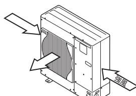
吹きさらしのような場所で風向きがわかっている時には、製品の吹出口を風向と直角になるようにする。
