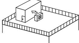
近くに壁などがある場合には壁面に吹出口が向くようにする。この時壁面までの距離は50cm程度にする。
