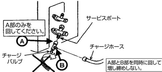
サービスポートに取付ける際に締め過ぎるとバルブコア(虫ピン)の変形、緩みによるガス洩れの恐れがあります。
