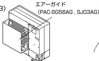
台風等の強風が吹出口に吹付けるような据付場所には別売エアガイドを取付けてください。
