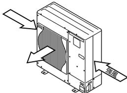
吹きさらしのような場所で風向きがわかっている時には、製品の吹出口を風向と直角になるようにする。
