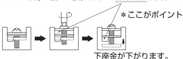
b.端子台に切り欠きがある場合は、電線を切り欠きに差し込みます。
