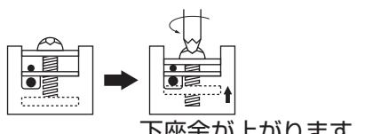
d.ネジをしっかりと締め付け、電線を固定します。
