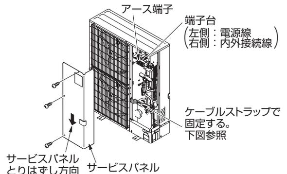
配線工事にて端子台に配線を接続する際は、室外ユニット内部機器の特に高温部(四方弁など)に接触しないように配線を引き回してください。
