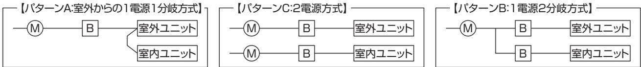
(M)は幹線の保護器、(B)は漏電遮断器を示す。
