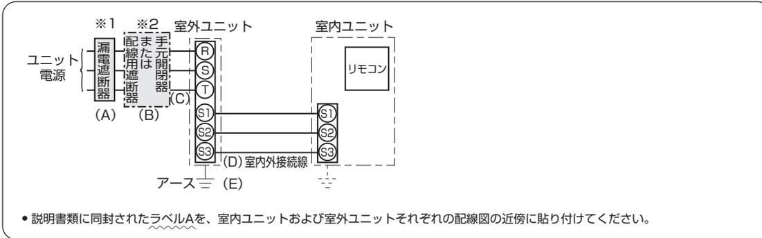
※1 電源には必ず漏電遮断器を取付けてください。
