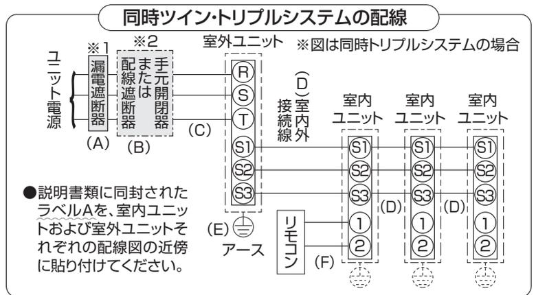
※1 電源には必ず漏電遮断器を取付けてください。漏電遮断器は、インバーター回路用遮断器(三菱電機製NV-Cシリーズまたは、その同等品)を選択してください。
