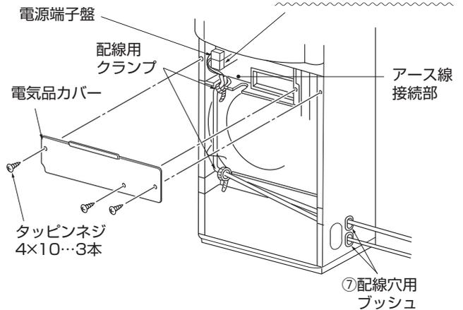
※電気品カバーは、電気品箱上部の爪の内側に確実に差し込んでから、ネジ止め固定してください。
