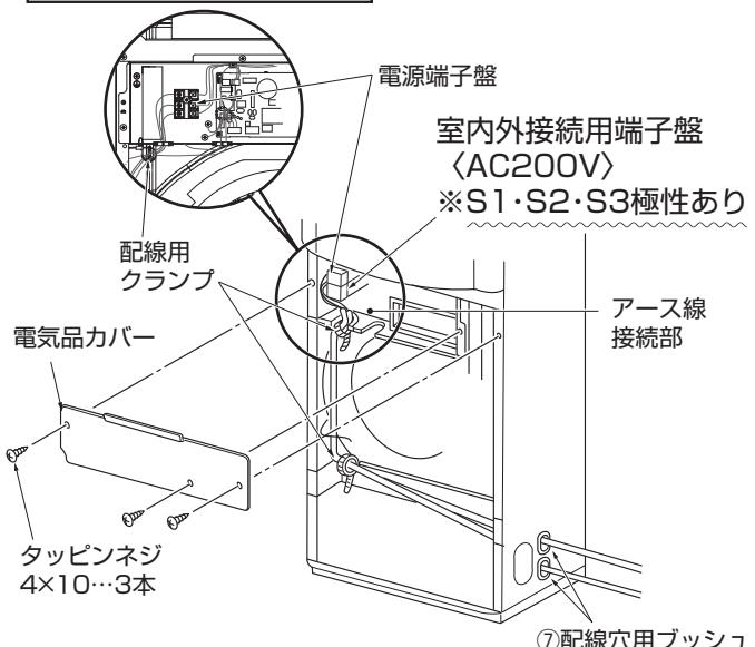
\*電気品カバーは、電気品箱上部の爪の内側に確実に差し込んでから、ネジ止め固定してください。
