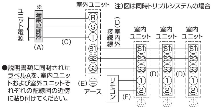
※ 電源には必ず漏電遮断器を取付けてください。漏電遮断器は、地絡・過負荷・短絡保護兼用のインバーター回路用遮断器（三菱電機製NV-Cシリーズまたは、その同等品）を選定してください。
