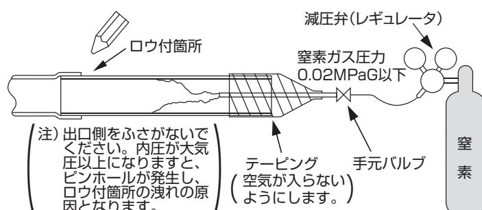
④冷媒配管接続後に現地接続配管と室内ユニットのガス洩れ検査を行ってください。
