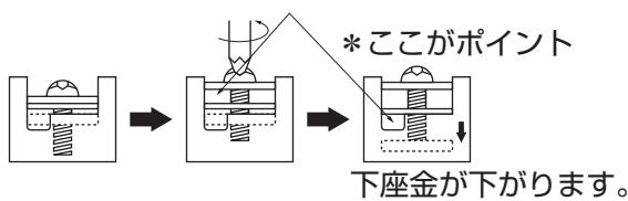
b.電線を端子台に切り欠きがある場合は、切り欠きに差し込みます。
