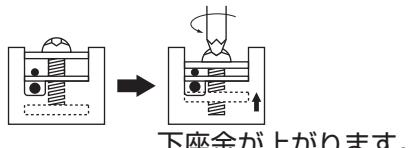
d.ネジをしっかりと締付け電線を固定します。
