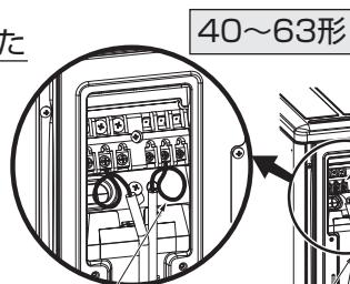
端子盤、およびアース端子へ接続する全てのリード線は、ループを作つて接続してください。
