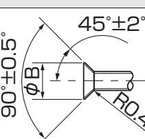
※従来のツールを使って冷媒R32用のフレア加工をする場合は、上表を参考に加工してください。
