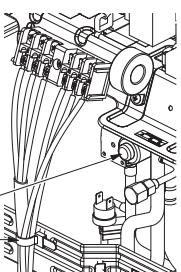
配線が圧縮機ターミナル部にかられないように引き回し、ケーブルストラップで固定してください。
