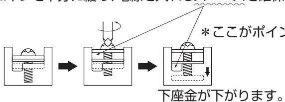
b.端子台に切り欠きがある場合は、電線を切り欠きに差し込みます。
