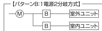
(M)は幹線の保護器、(B)は漏電遮断器を示す。
