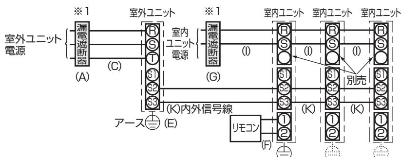
※1 地絡・過負荷・短絡保護兼用のインバーター回路用遮断器(三菱電機製NV-Cシリーズ又は、その同等品)を選定してください。
