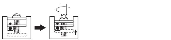
d.ネジをしっかりと締め付け、電線を固定します。
