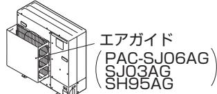
台風などの強風が吹出口に吹き付けるような据付場所には別売エアガイドを取り付けてください。
