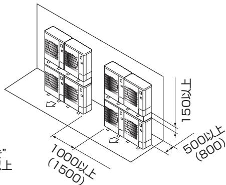
複数台設置される場合、据付工事、サービス、メンテナンス時に個々の室内・室外ユニットの組合せが
