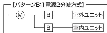
(M)は幹線の保護器、(B)は漏電遮断器を示す。
