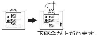
d.ネジをしっかりと締め付け、電線を固定します。
