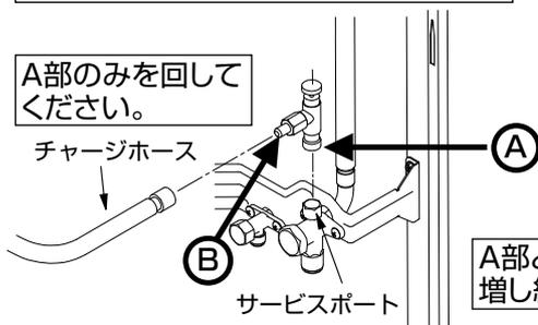
サービスポートに取り付ける際に締め過ぎるとバルブコア(虫ピン)の変形、緩みによるガス漏れのおそれがあります。B部の方向を決めてから、A部のみを回転させて締め込んでください。A部を締め込んだ後、A部とB部を同時に回して増し締めしないでください。
