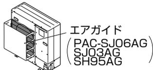
台風などの強風が吹出口に吹き付けるような据付場所には別売エアガイドを取り付けてください。
