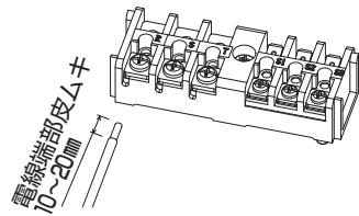
⑤電源線に丸型圧着端子などの端末処理が出来ない場合、または単線(内外配線用のVVF)の場合は以下の作業手順に従い配線を行ってください。
