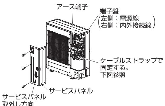
配線工事にて端子盤に配線を接続する際は、室外機内部機器の特に高温部(四方弁など)に接触しないように配線を引き回してください。
