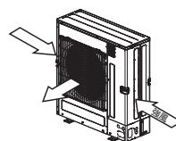
吹きさらしのような場所で風向きがわかっている時には、製品の吹出口を風向と直角になるようにする。
