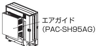
台風などの強風が吹出口に吹き付けるような据付場所には別売エアガイドを取り付けてください。
