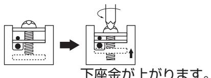
d.ネジをしっかり締付け電線を固定します。
