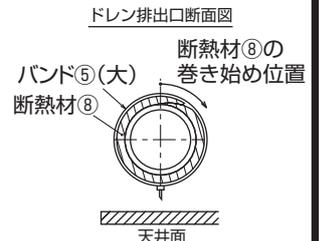
※断熱材⑧の巻き始めが据付状態で上側になるように貼付する。
