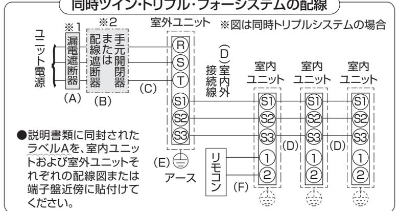
●説明書類に同封されたラベルAを、室内ユニットおよび室外ユニットそれぞれの配線図または端子盤近傍に貼付けてください。
