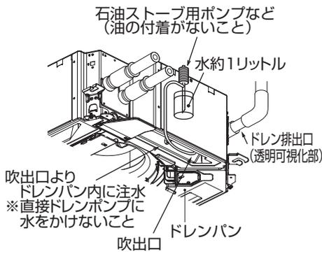
注1) 左記水量を注水しても排水確認ができない場合は、水平に据付けられていない可能性があります。水準器などを使用して本体が水平に設置されているか確認してください。また、必要以上の水を注水するとドレンポンプが水没し、故障の原因になります。
