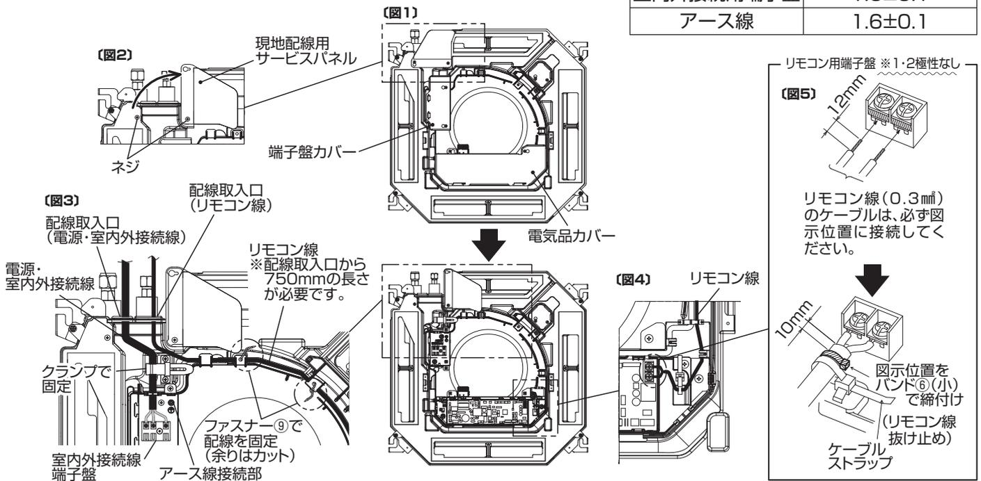
1. 内外接続線にVVF平形ケーブルを使用する場合は以下の作業手順に従い配線を行ってください。
