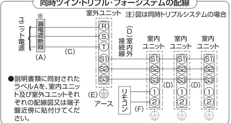
●説明書類に同封されたラベルAを、室内ユニット及び室外ユニットそれぞれの配線図又は端子盤近傍に貼付けてください。
