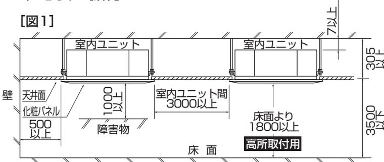
※本製品は据付ける部屋の天井高さに合わせて、現地設定を行う必要があります。設定方法は14ページをご覧ください。(ムーブアイセンサーパネルの場合は、専用の設定を行う必要があります。)
