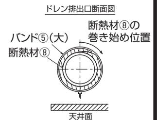
※断熱材⑧の巻き始めが据付状態で上側になるように貼付する。
