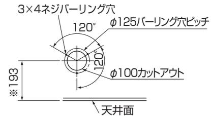
注) 図中の※印部の寸法は、別売外気取入用ケースメントを取付けた場合135mm加算します。
